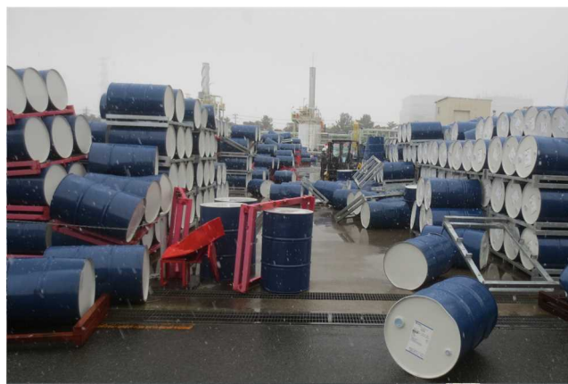
脱落したドラム
