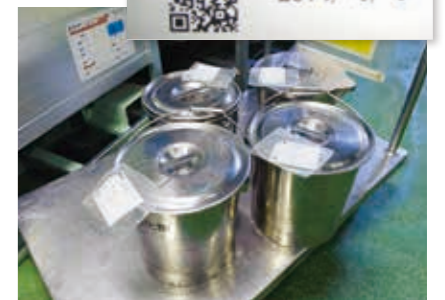
QRコードによる管理 全ての原料にQRコードが付いたラベルを貼付。原料受入、製造、出荷を通して、QRコードを活用したトレーサビリティシステムで管理しています
