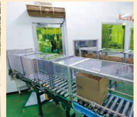
段ボール搬送ラインにトンネルカバーを設置
